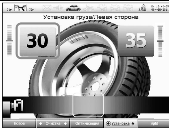
Рисунок 5.12 – Экран при установке груза линейкой
